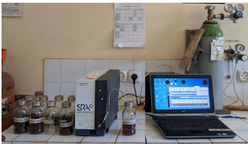
Cliché 4 : Mesure de l'émission de CO 2 avec un chromatographe en phase gazeuse
